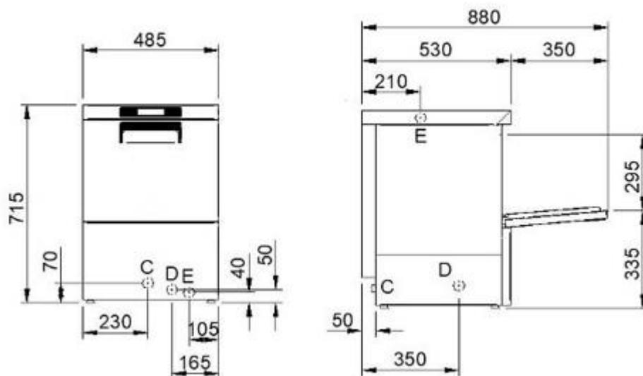
D = SCARICO 1", VIDANGE 1", DRAIN 1", ABFLUSS 1"; DESAGÜE 1"; СЛИВ 1"
